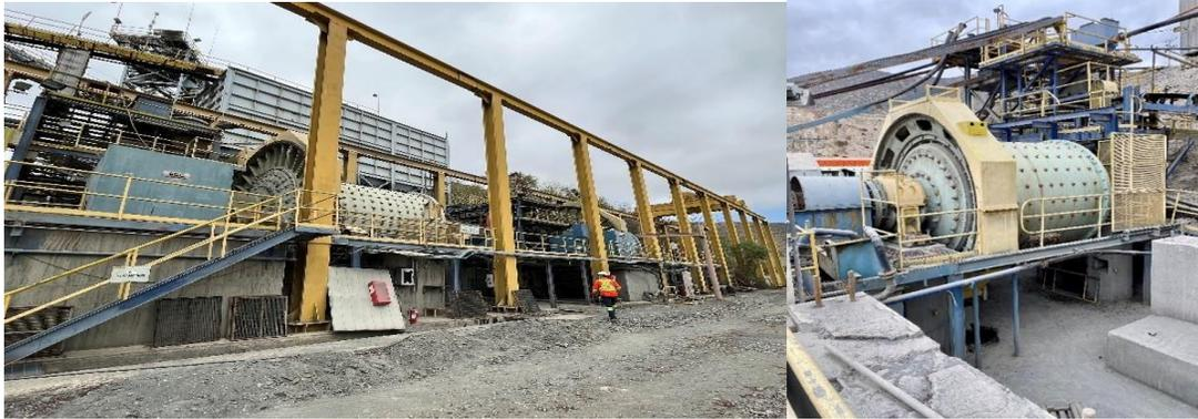
Figura 3. Los dos molinos de molienda primaria in situ (izquierda) y uno de los dos molinos de bolas del sistema de molienda secundaria (derecha).
